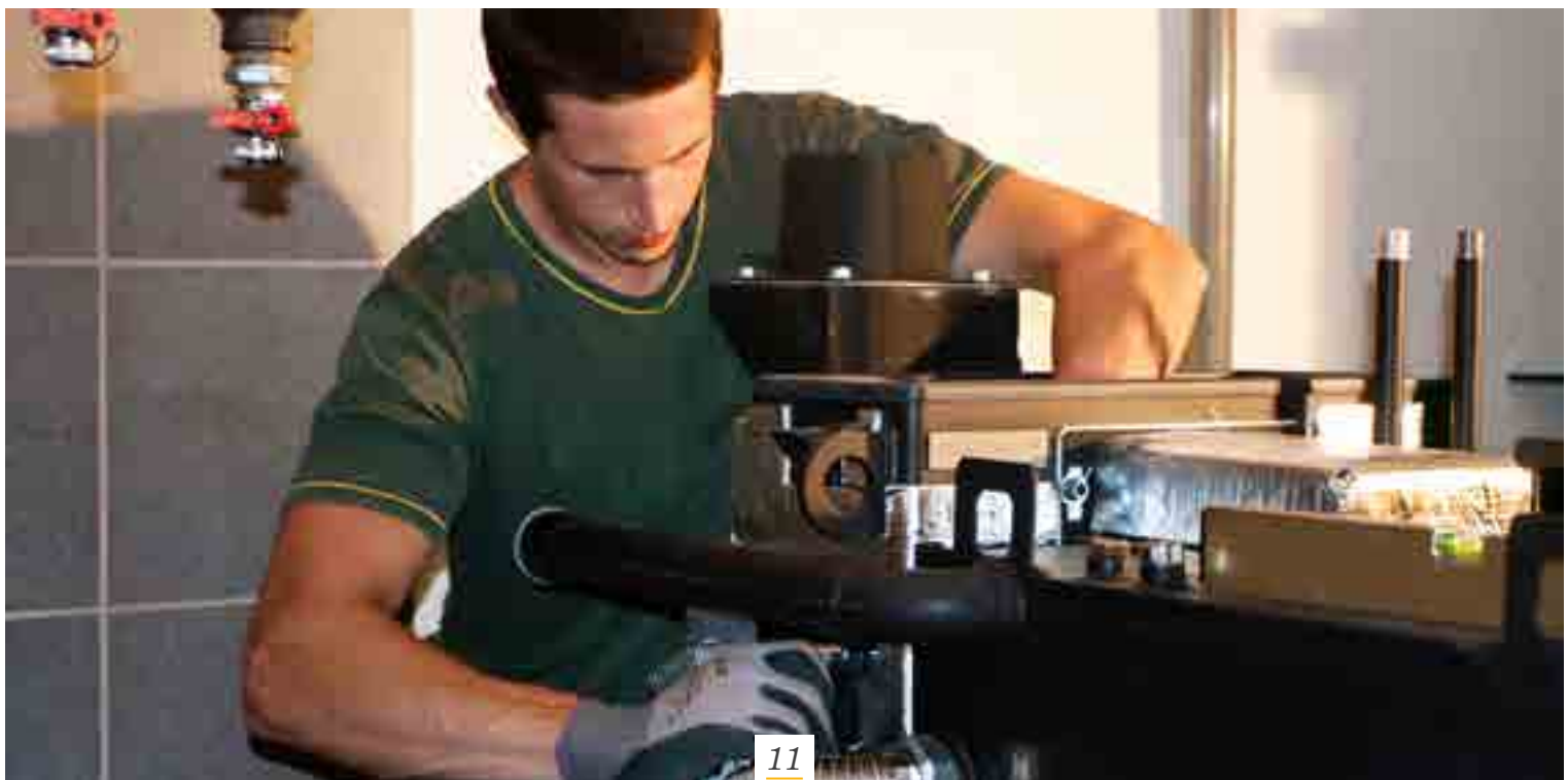
KWB Easyfire, caldaia scomponibile in 2 pezzi
