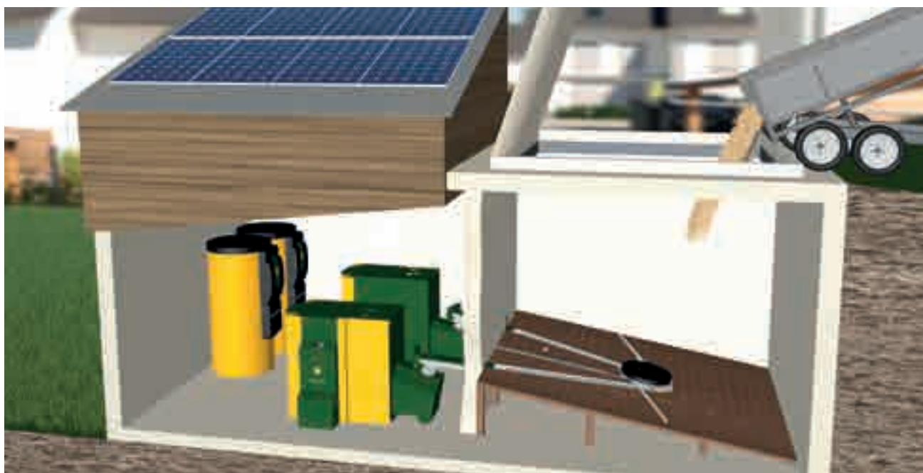
KWB Multifire con impianto doppio con agitatore e 2 coclee di trasporto: caricamento diretto del deposito
